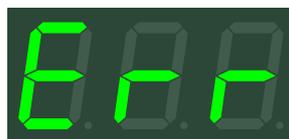
Otra condición de error se producirá si, luego de presionar la tecla “**Borrar**” inicialmente, vuelve a presionarse la misma tecla al estar ingresando los dígitos de la clave personal. También puede producirse una condición de error durante la programación del frente de calle (ver “*Programación del frente de calle*”).
